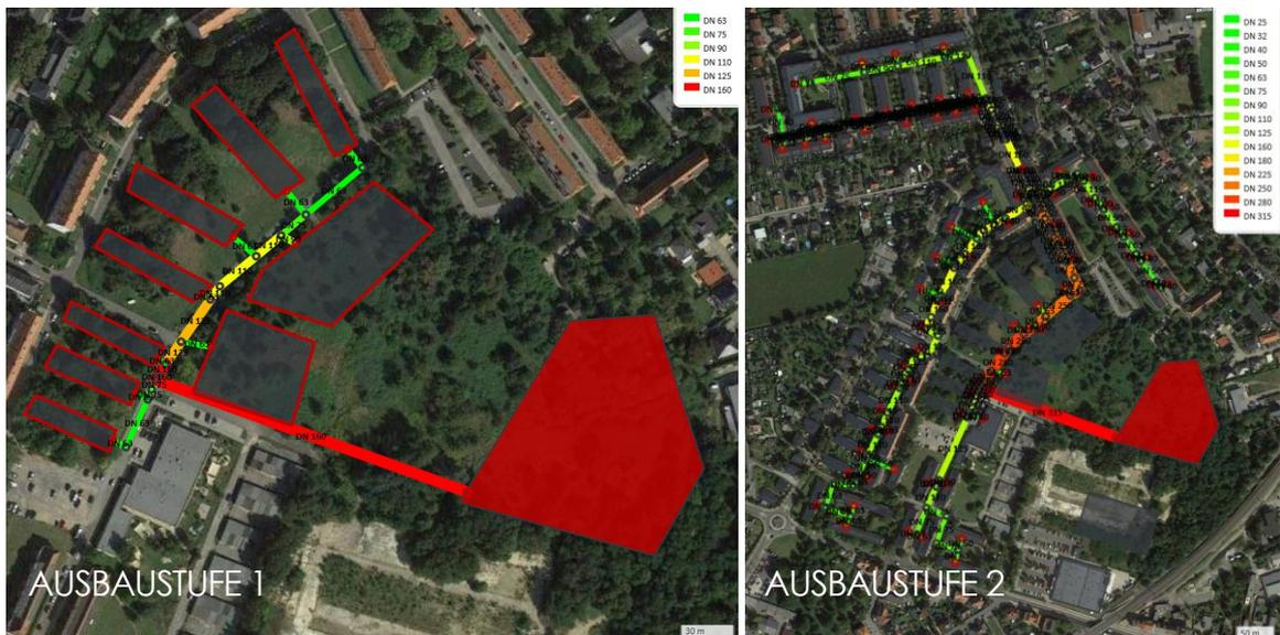
Abbildung 1: Dimensionierung des Wärmenetzes für die beiden Ausbaustufen
