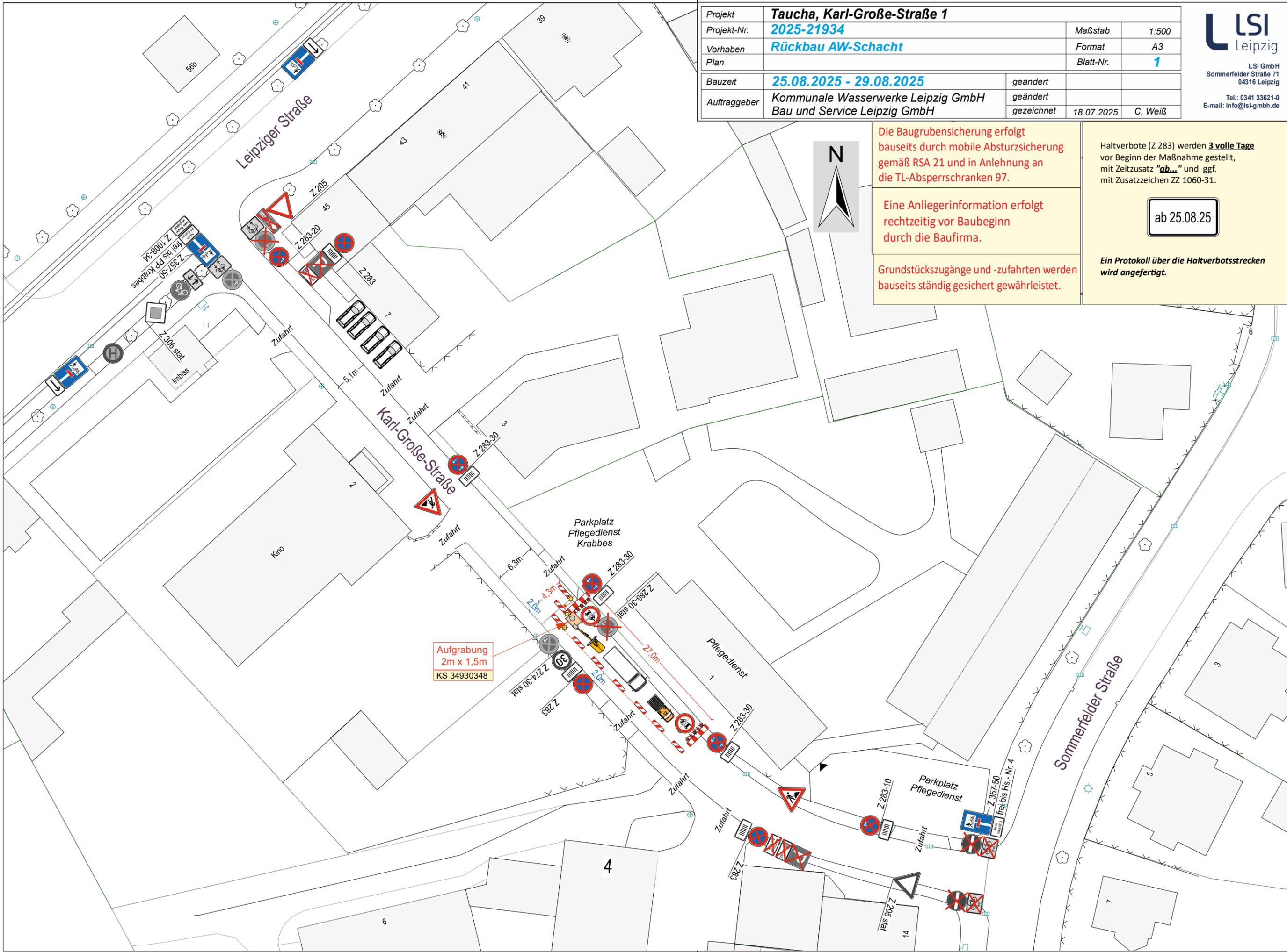
Die Baugrubensicherung erfolgt bauseits durch mobile Absturzsicherung gemäß RSA 21 und in Anlehnung an die TL-Absperrschranken 97.
