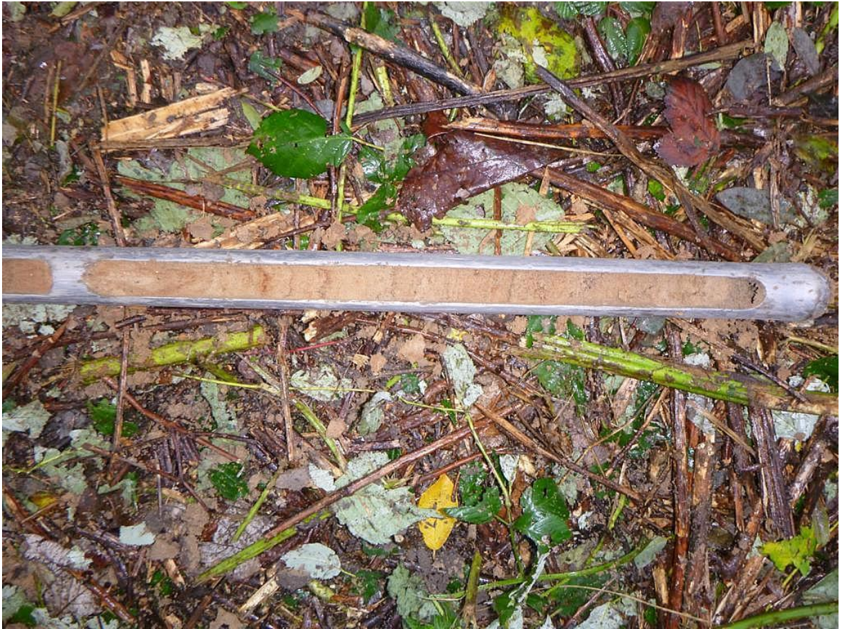
Bild 5: Bohrung 1, Mittelsand, feinsandig, mittlerer Bereich bei 2,5-3,0 m.
