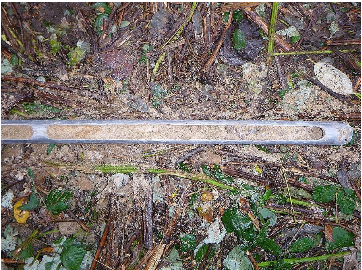
Bild 6: Bohrung 2, Mittelsand, schwach mittelkiesig, mittlerer Bereich bei 2,5-3,0 m.
