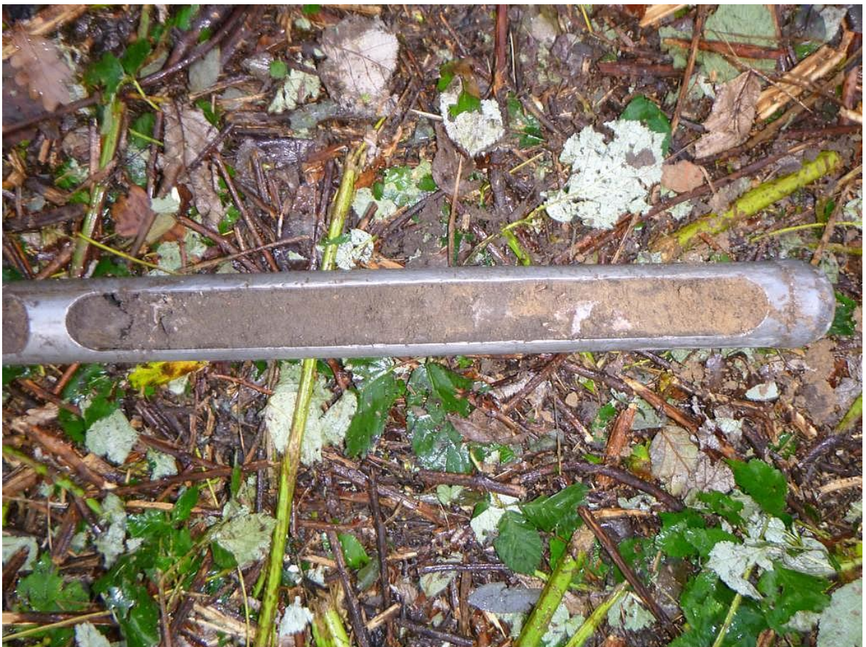
Bild 4: Bohrung 1, schluff-sandig-kiesig, Auffüllung bis 0,8 m, dann Mittelsand, schluffig.
