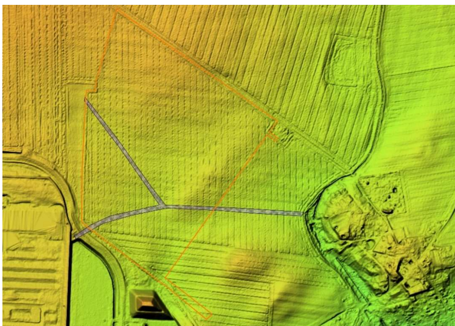
Abbildung 9: Unterirdisches Drainagesystem im B-Plangebiet (DGM 2 als Schummerungsbild unterlagert)
