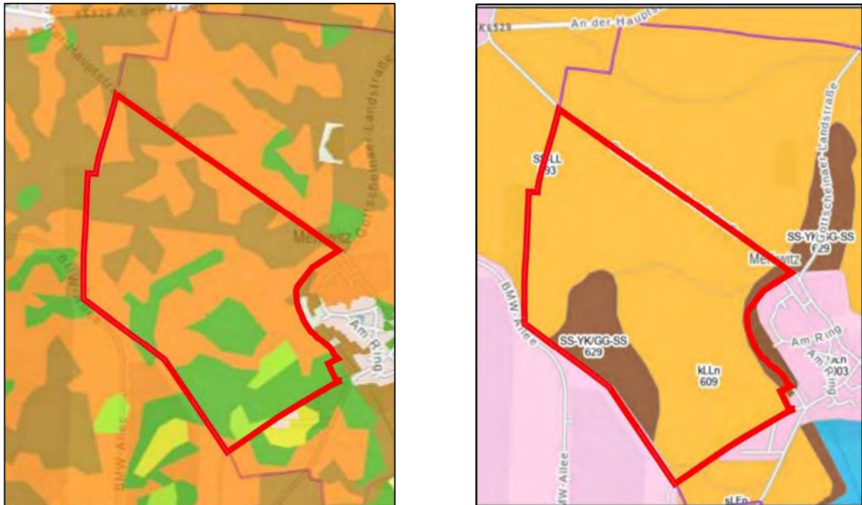
Abbildung 8: Bodenarten (links) und Bodentypen (rechts) © iDA Datenportal
